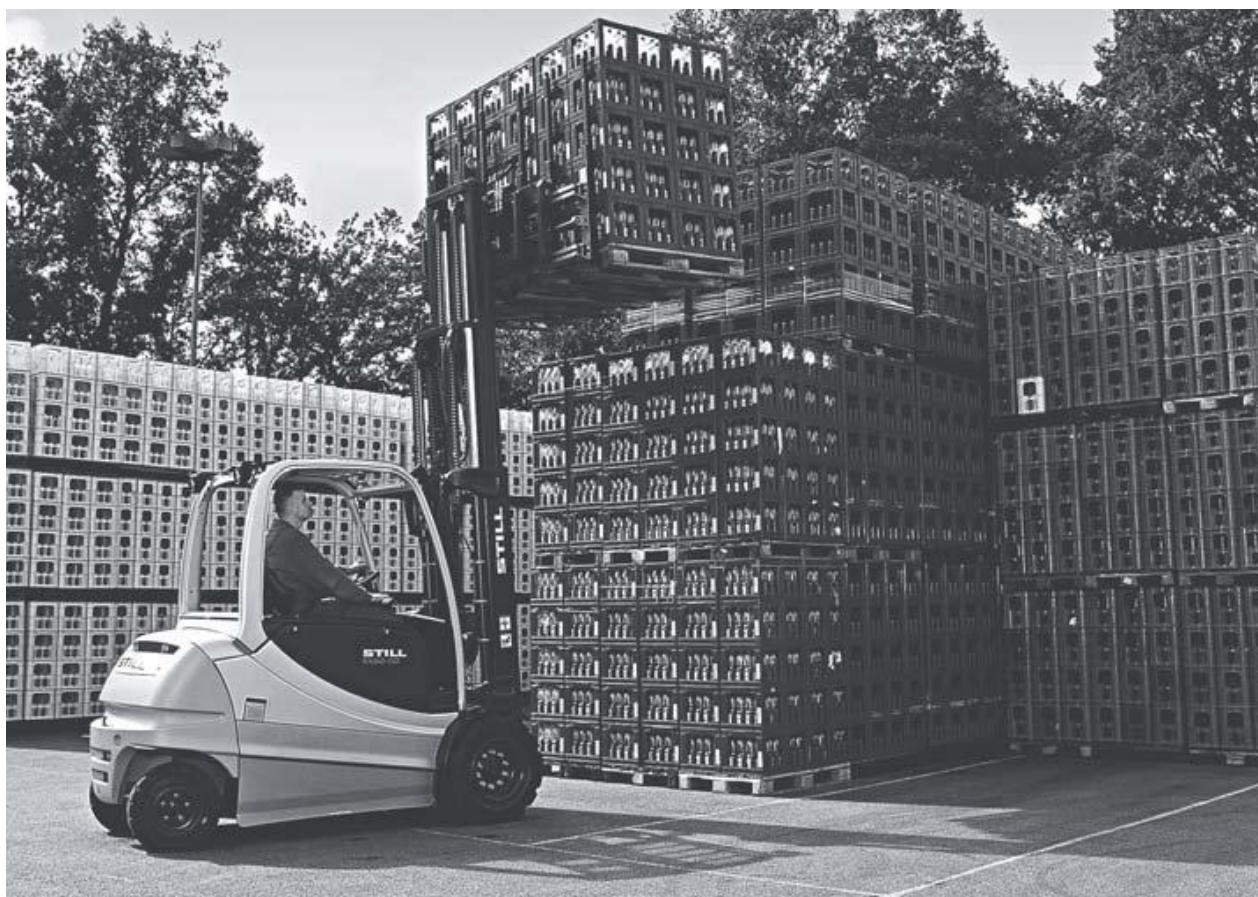
Exécution antidéflagrante avec composants électriques encapsulés
