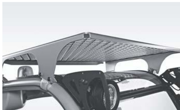
Protection supplémentaire contre les chutes de petits objets
