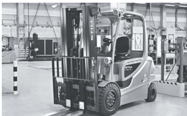
Exécution antidéflagrante avec composants électriques encapsulés
