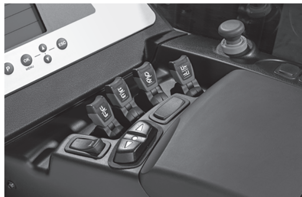
Pilotage simple de toutes les fonctions sans changement de position de la main - par à l'aide quatre mini-leviers (Fingertip)
